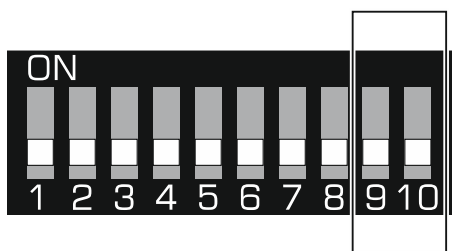
Rys. 2. Przełączniki służące do określenia trybu pracy kontrolera.
