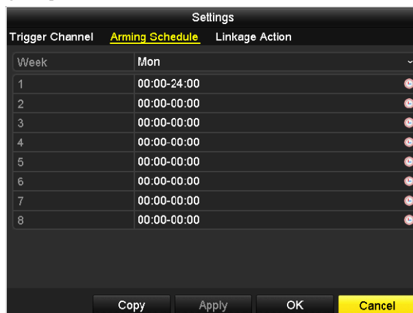
Figure 8. 3 Ustawianie harmonogramu uzbrajania wykrywania ruchu
