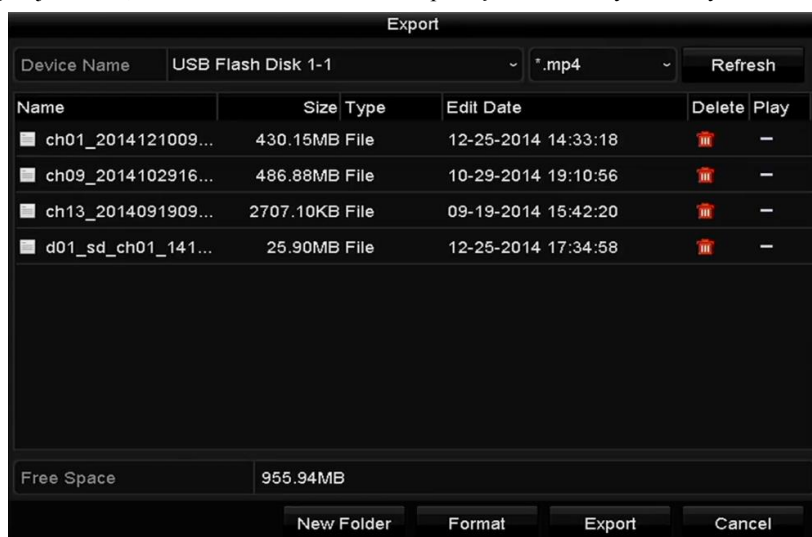
Figure 7. 7 Eksport na podstawie normalnego wyszukiwania wideo, przy użyciu pamięci USB
