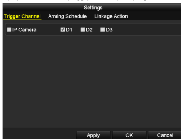
Figure 8. 2 Ustawianie kamery wyzwalanej po wykryciu ruchu
