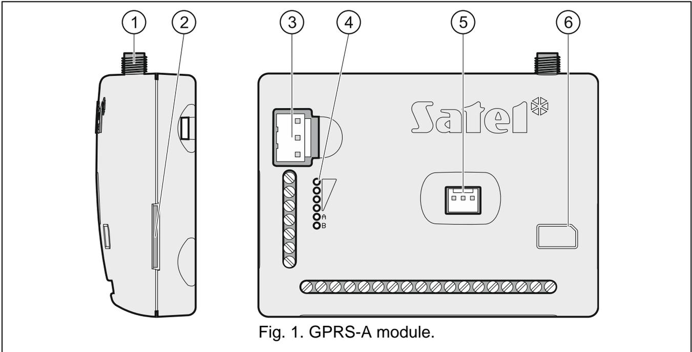
Fig. 1. GPRS-A module.
