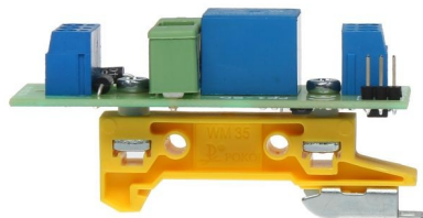
Rys. 2a Montaż na szynie DIN za pomocą podstawki montażowej WM-35 i dystansów 3mm.
