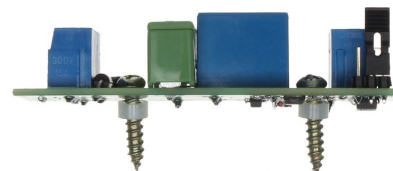
Rys. 2c Montaż za pomocą wkrętów i dystansów 3mm.
