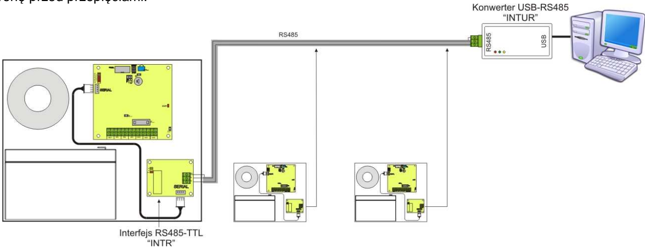
Rys. 23. Komunikacja RS485 z wykorzystaniem interfejsów „INTR” oraz „INTUR”.
