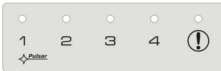
Rys.4. Widok panelu zasilacza.
