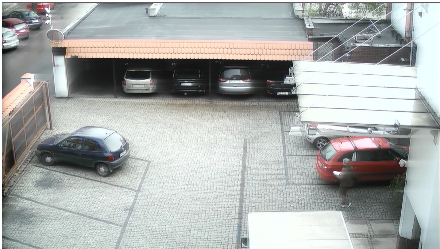
1.10 System AHD. Kabel TRISET-113 bez regeneratora. Długość 1000m.
