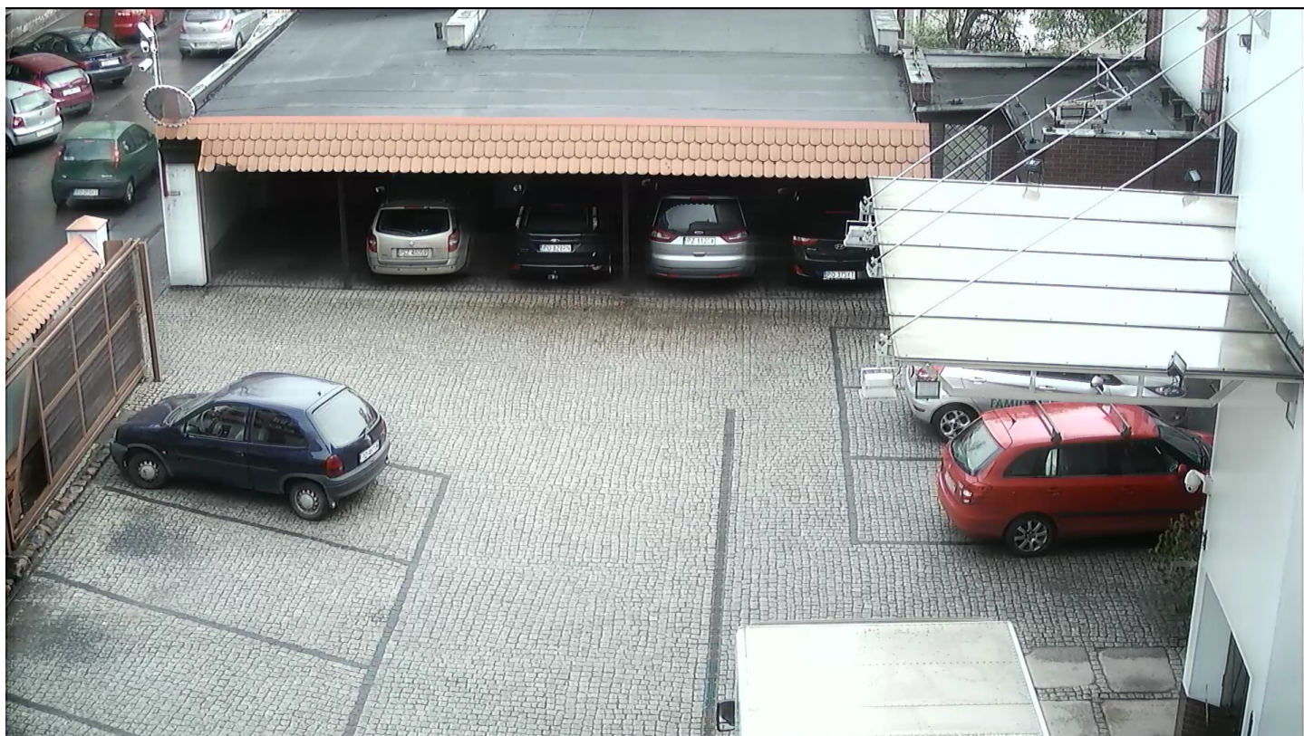
1.6 System AHD. Kabel TRISET-113 bez regeneratora. Długość 600m.
