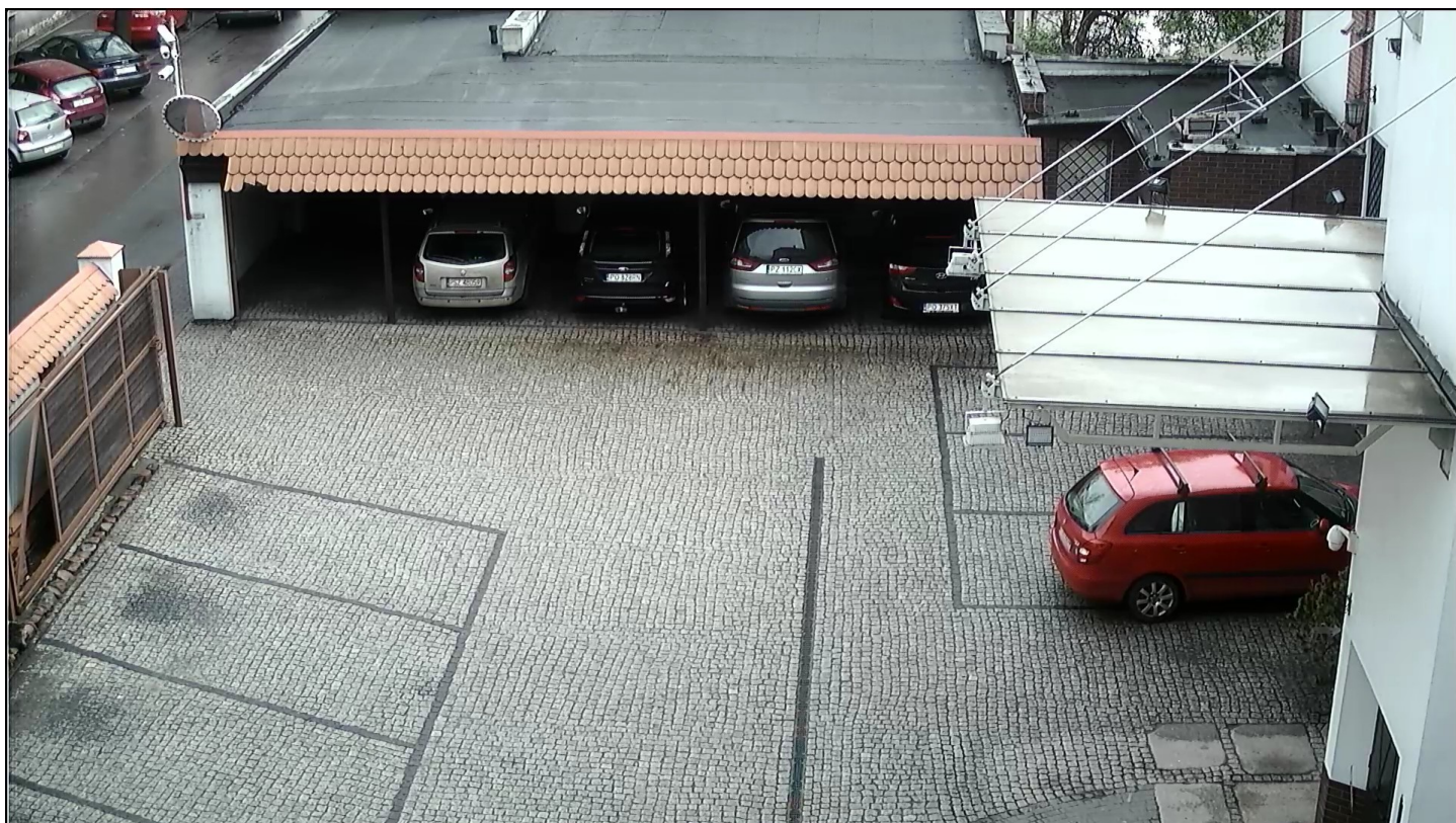
1.2 System AHD. Kabel TRISET-113 bez regeneratora. Długość 200m.
