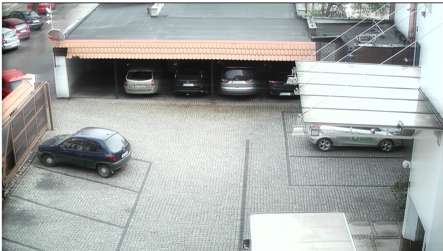
1.9 System AHD. Kabel TRISET-113 bez regeneratora. Długość 900m.
