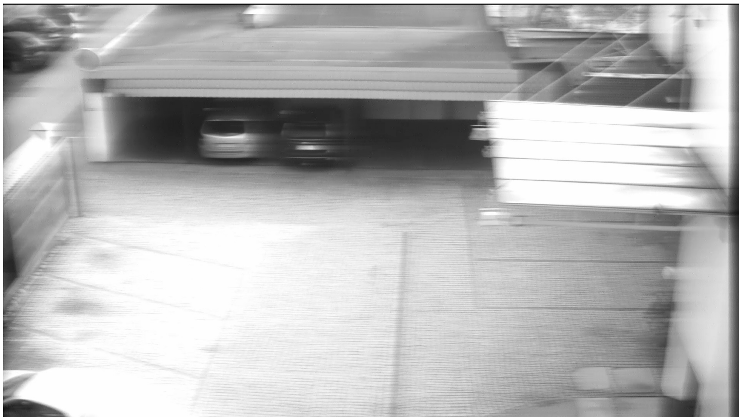
1.7 System AHD. Skrętka bez regeneratora. Długość 700m.
