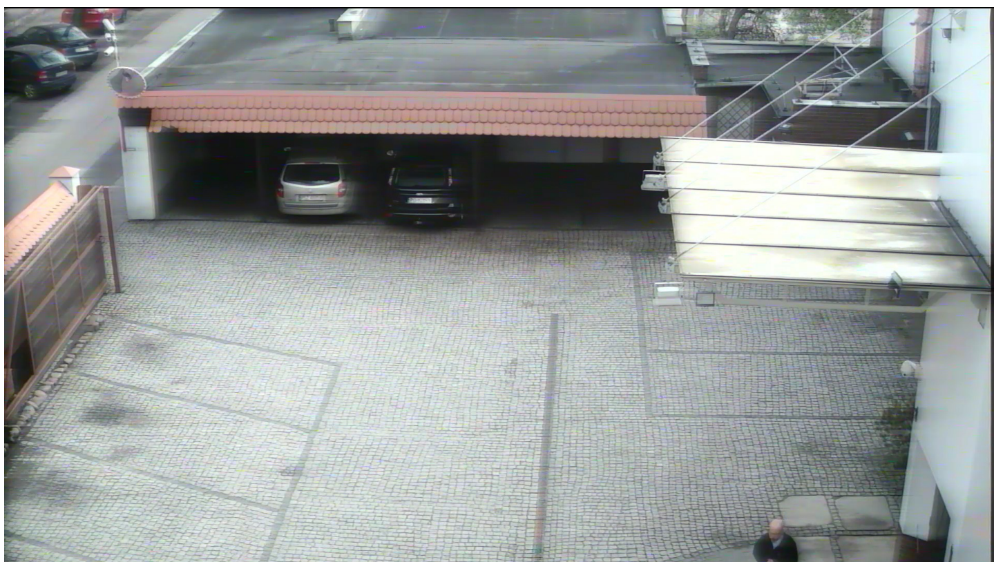
1.5 System AHD. Skrętka bez regeneratora. Długość 400m.
