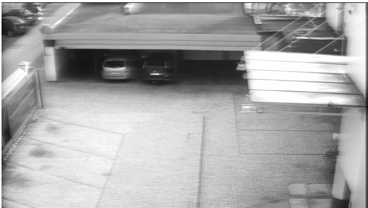
1.5 System AHD. Skrętka bez regeneratora. Długość 500m.
