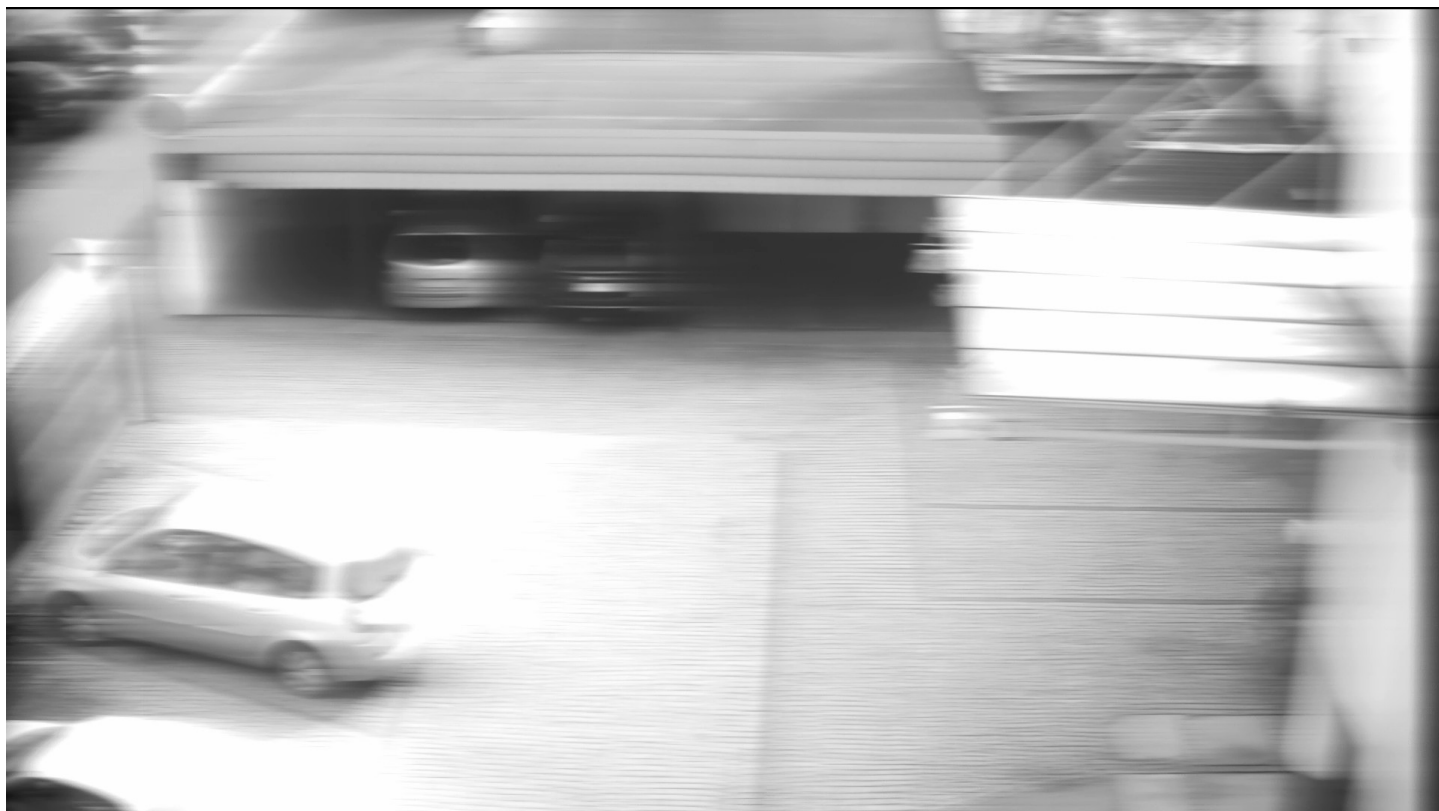
1.9 System AHD. Skrętka bez regeneratora. Długość 900m.
