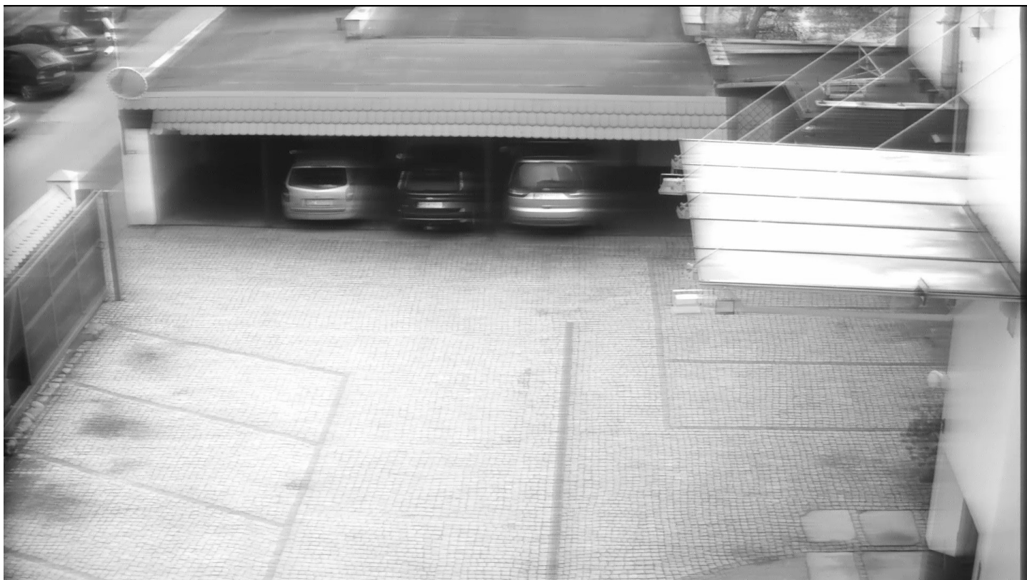
2.6 System AHD. Skrętka z regeneratorem na końcu kabla. Długość 600m.
