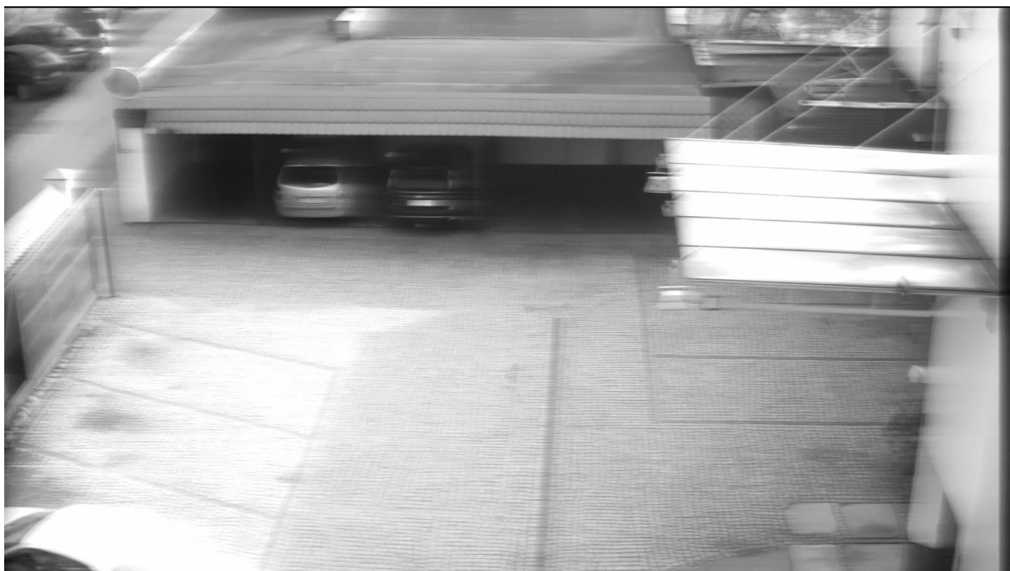
1.6 System AHD. Skrętka bez regeneratora. Długość 600m.
