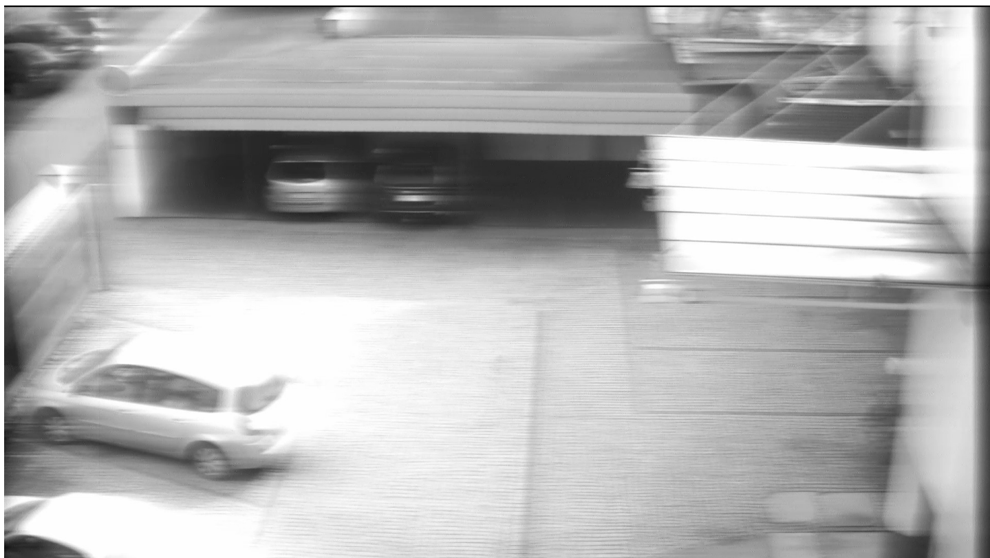
1.8 System AHD. Skrętka bez regeneratora. Długość 800m.
